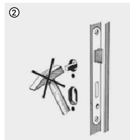
② Der Drückerstift darf nicht mit Gewalt durch die Schlossnuss geschlagen werden.
