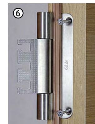
6 Edelstahlabdeckung mit mitgelieferten Holzschrauben 5,0 x 50 befestigen
