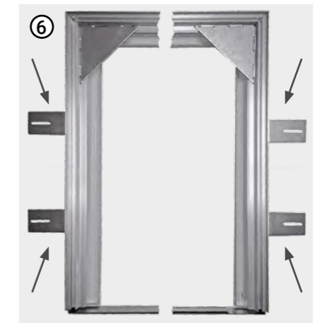
⑥ Montagebügel eindrehen (3 Stk. pro Steher) und montieren, Positionierung bei Bändern und Schloss.
